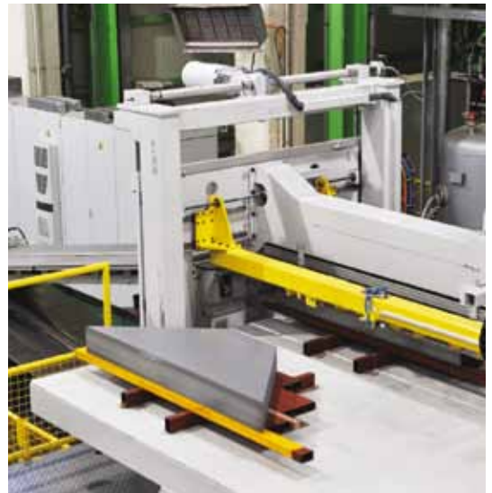
· AUTO CORE CUTTING MACHINE (CUT TO LENGTH) 규소 강판은 이음새의 틀을 최소화하기 위해 PLC로 자동 절단합니다.
